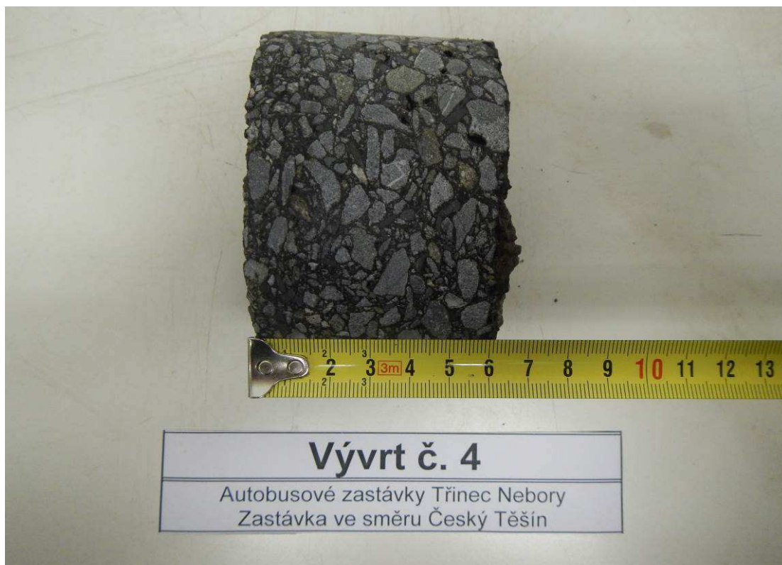
Foto č. 4 – Detail vývrtu č. 4
